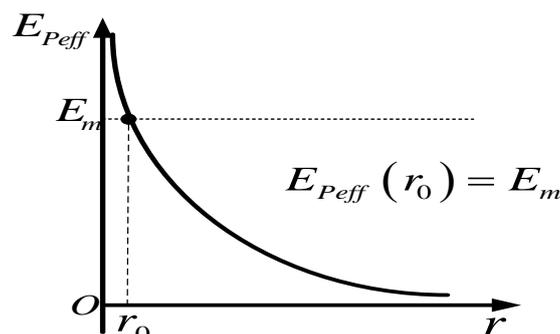
L'énergie  $E_m$  doit aussi être positive : c'est une somme de carré. La quantité  $\frac{1}{2}m\dot{r}^2 = E_m - E_{peff}$  est positive ou nulle. Les valeurs de  $r$  au cours du mouvement varient entre  $r_0$  et  $+\infty$ . Une particule arrivant de l'infini se rapproche du pôle ; sa vitesse radiale diminue,  $E_{peff}$  augmentant à la distance  $r_0$ , cette vitesse s'annule et la particule s'éloigne à nouveau jusqu'à l'infini : **c'est un état de diffusion**.
